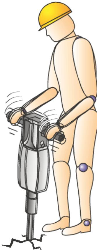
Slika B.1 Vibracije koje se prenose na šake i ruke
