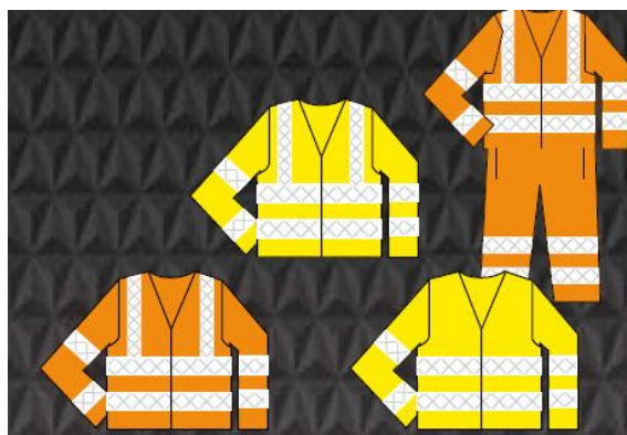
Slika br. 22. Vrste zaštitne odjeće visoke vidljivosti s obzirom na razinu zaštite a) klasa 1, b) klasa 2, c) klasa 3
