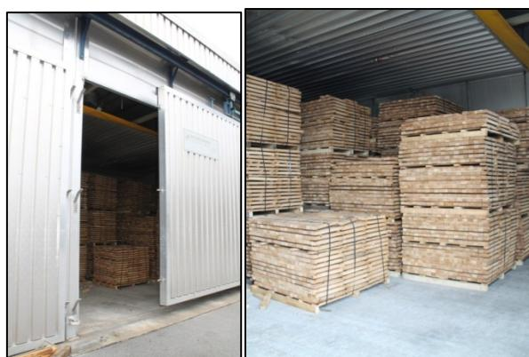
**Slika 39:** Palete složene piljene građe unutar sušare
