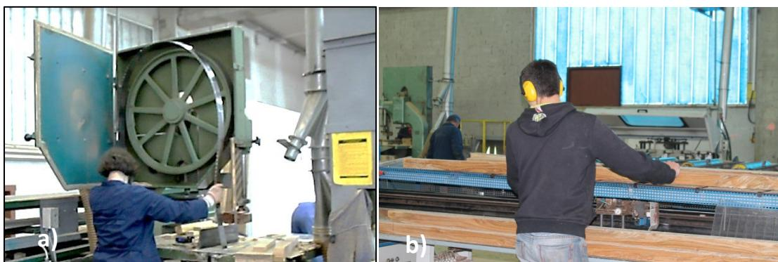
**Slika 32:** Ručno podešavanje vodilice lista tračne pila (a) i ručno prinošenje drveta za obradu (b)
