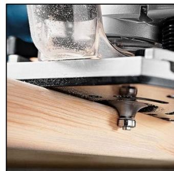
**Slika 50:** Ručna glodalica
