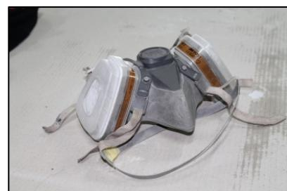
**Slika 5:** Polumaska s filtrom za zaštitu od organskih plinova i para koje je naveo proizvođač, vrelišta iznad 65° C
