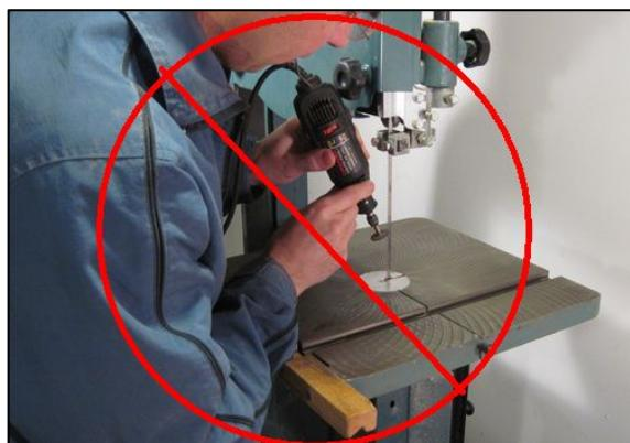
**Slika 48:** Nepravilan postupak oštrenja zupca tračne pile
