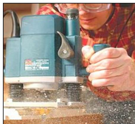
**Slika 51:** Rad s ručnom el. glodalicom
