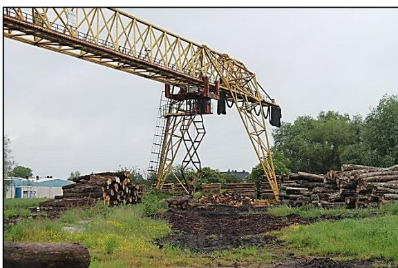
**Slika 22:** Portalna dizalica za prenošenje trupaca do pilane
