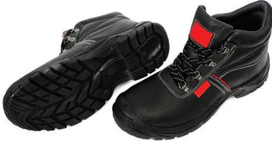
**Sigurnosna obuća je obuća definirana normom HRN EN ISO 20345:2012 koja kao osnovni zahtjev (SB) postavlja kapicu otpornosti 200 J (TC 200 J), otpornost na loživa ulja (FO) te zaštitu od klizanja (SR).**
