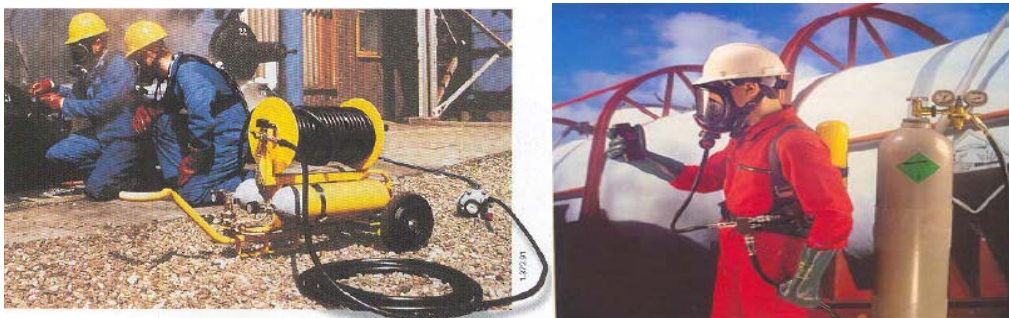
Slika 15. Cijevni uređaj s priključkom na izvor komprimiranog zraka
