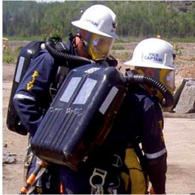
Slika 17. Aparati sa zatvorenim sustavom cirkulacije (na komprimirani kisik ili kemijski vezani kisik)
